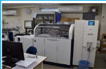
臨床化学自動分析装置 1時間に2,000テスト処理出来ます。測定項目は約130項目ですが当検査室では約40項目測定しています。
