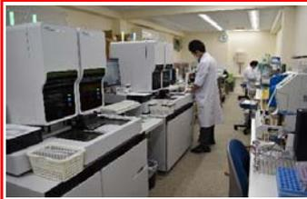
多項目自動血球分析装置 1時間に100検体処理します。測定項目は白血球・赤血球・ヘモグロビン・血小板等の数や血球の分類を検査します。
